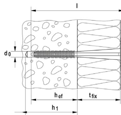
$t_{fix}$  = spessore di isolamento + colla + intonaco esistente
